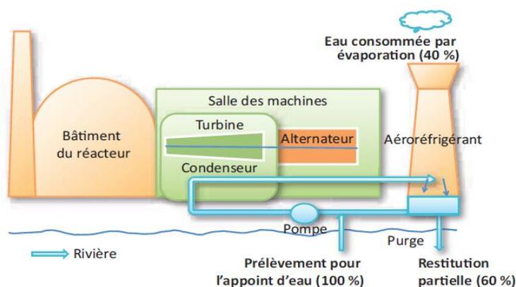
**Figure 1 : Schéma d'un CNPE avec un circuit de refroidissement fermé**
