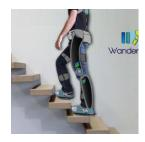
Wandercraft développe un exosquelette robotisé, intuitif et facile d'utilisation destination de personnes à mobilité réduite. Equipé d'une centrale à inertie, l'exosquelette ne nécessite pas de manette ni de joystick et est directement commandé par le buste de la personne, qui d'un simple mouvement vers l'avant ou l'arrière peut avancer ou s'arrêter. L'objectif est de reproduire la marche naturelle au travers d'un exosquelette discret, esthétique, et à faible consommation d'énergie.
