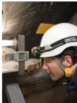
Surveillance du barrage à l'aide d'un pendule
