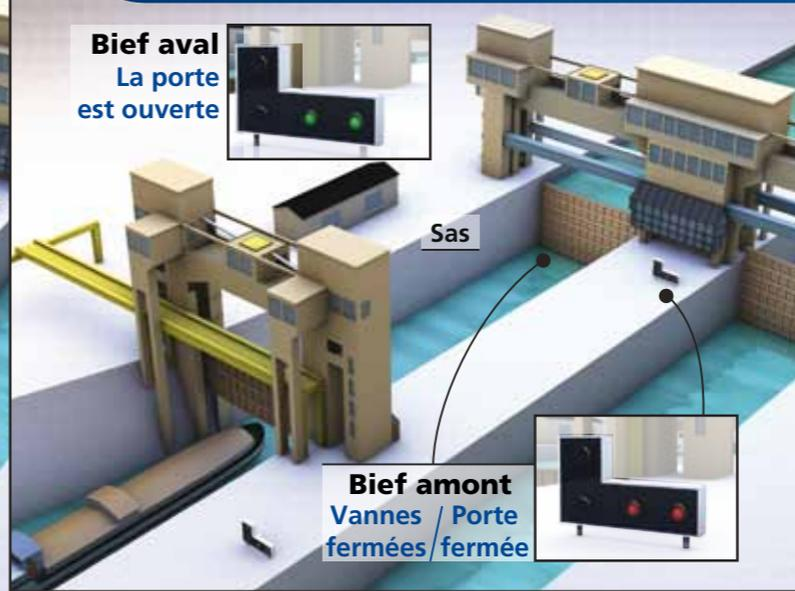
**2** Le bateau entre dans l'écluse. Le navigant s'amarré aux différents bollards flottants (systèmes d'amarrages situés dans le sas qui permettent de maintenir le bateau stable pendant la manoeuvre), puis éteint son moteur. Une fois le bateau bien amarré et correctement en place, l'éclusier va refermer la porte aval.
