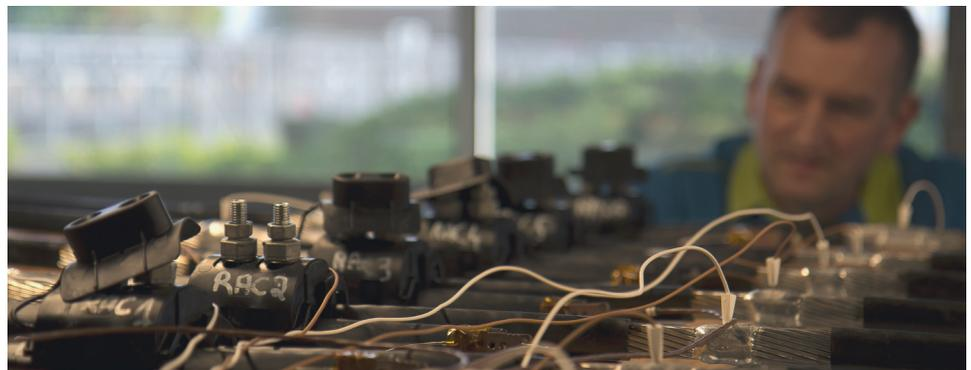
Préparation d'une boucle d'essais de raccords
