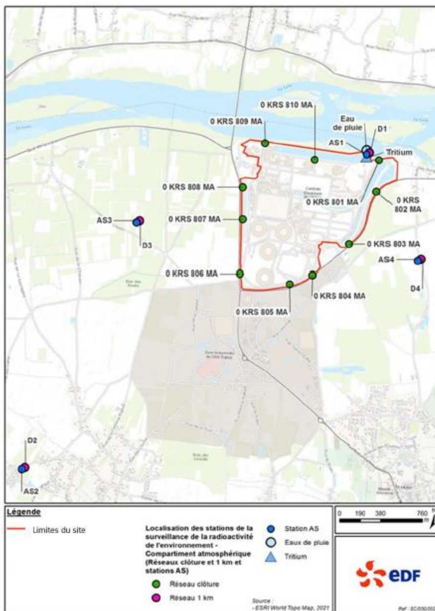
Figure 2 : Localisation des stations de la surveillance de la radioactivité de l'environnement - réseaux clôture et 1 km
