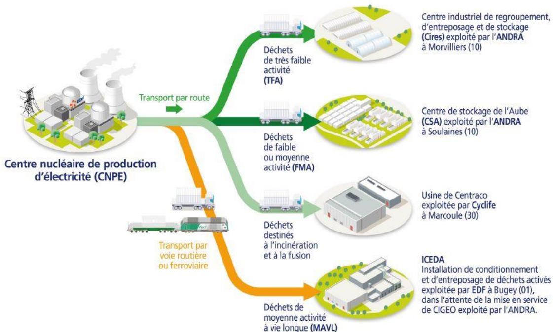
**Figure 6 : Transport des déchets radioactifs (Source : EDF)**
