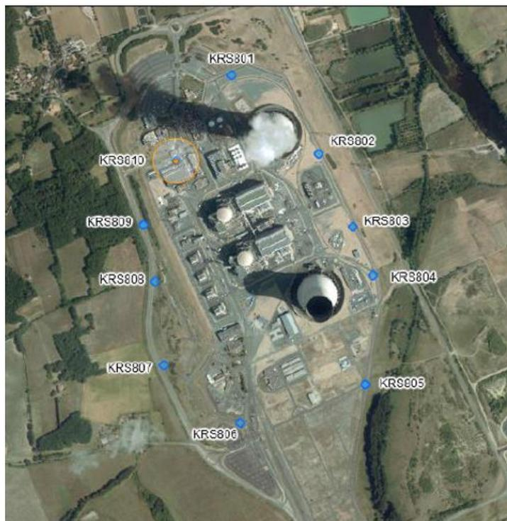
**Réseau des balises radiométriques « 1Km »**
