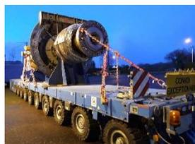
Le moulinet, un ensemble de pièces de 87 tonnes, sera transporté par convoi exceptionnel entre l'usine marémotrice et l'atelier de maintenance mécanique EDF Hydro situé à Dinard où il sera entièrement rénové. Cet ensemble est le plus lourd d'un groupe de production d'électricité que l'on manutentionne. Il mesure 7 m de long et peut atteindre un diamètre de 3,2 m.
