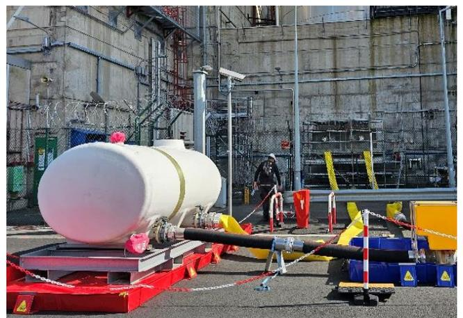
[Test grandeur nature] Une cuve remplie d'eau avec la pompe a été raccordée sur les dispositifs de la FARN. En situation réelle, l'eau serait prélevée de la Loire.
