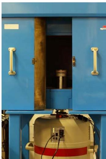
Photo 7. Chaîne de spectrométrie gamma
