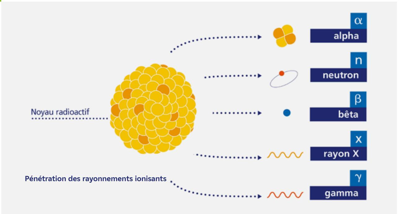
**LE PHÉNOMÈNE DE LA RADIOACTIVITÉ** est la transformation spontanée d'un noyau instable en un noyau plus stable avec libération d'énergie. Ce phénomène s'observe aussi bien sur des noyaux d'atomes présents dans la nature (radioactivité naturelle) que sur des noyaux d'atomes qui apparaissent dans les réacteurs nucléaires, comme les produits de fission (radioactivité artificielle). Cette transformation peut se traduire par différents types de rayonnements, notamment :
