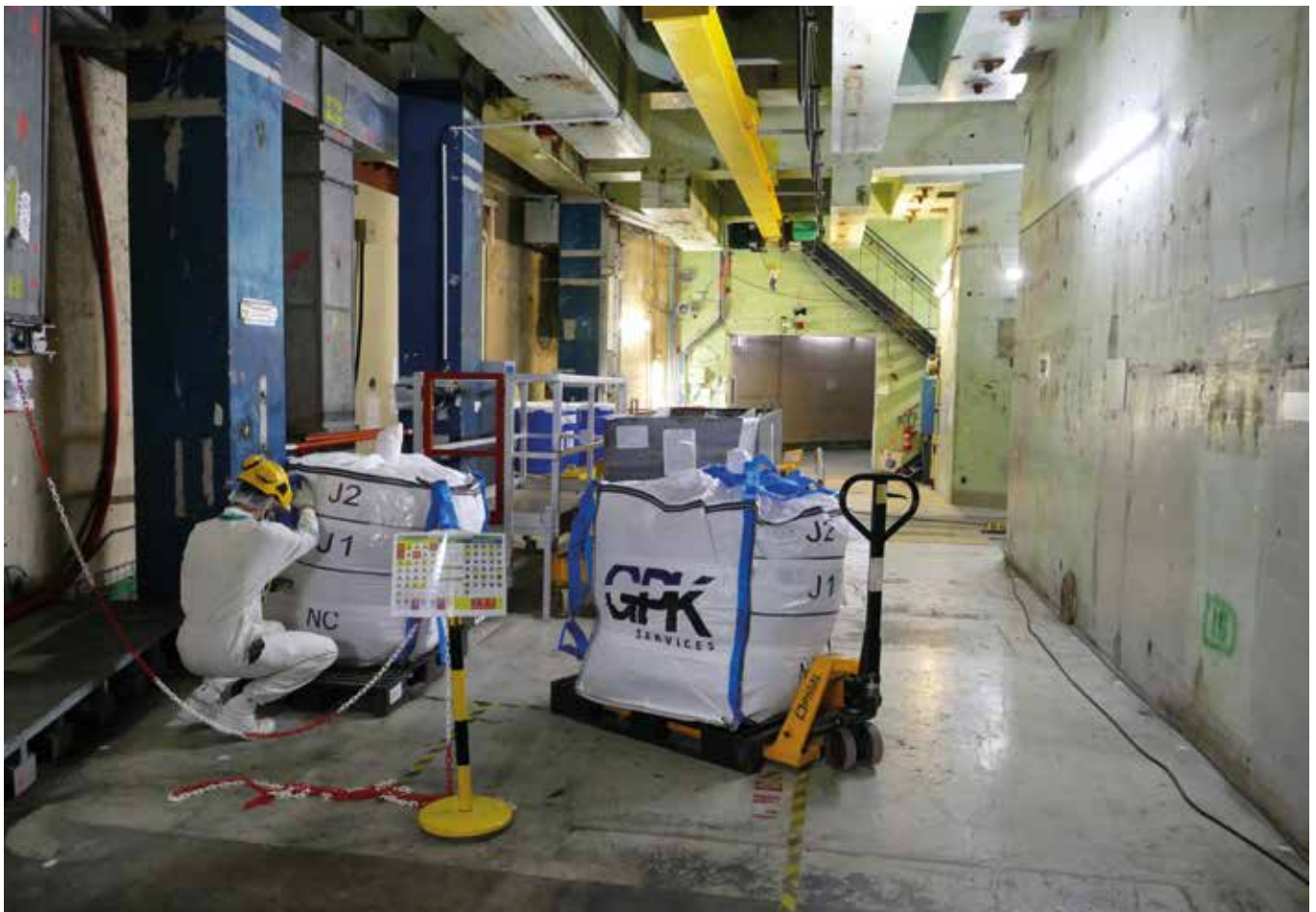
Contrôle de déchets très faiblement actifs.
