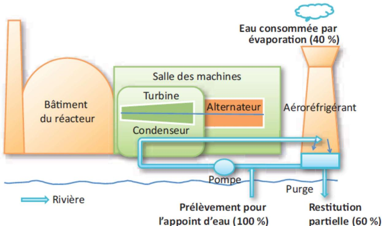
Figure 1 : Schéma d'un CNPE avec un circuit fermé (Source : EDF)
