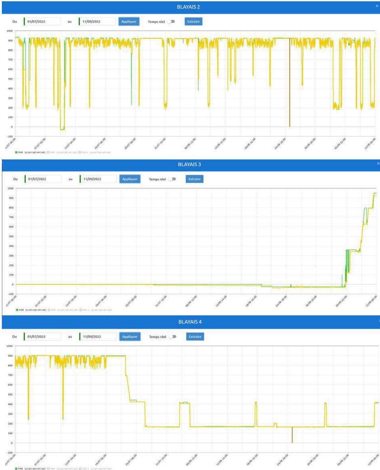
Figure 8 : Puissance (en MWe) des tranches 1, 2, 3 et 4 du CNPE du Blayais entre le 1er juillet 2022 et le 11 septembre 2022. La courbe verte correspond au programme émis par la DOAT et la courbe jaune à la puissance réelle réalisée.
