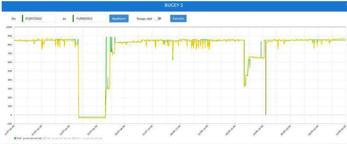
Figure 4 : Puissance (en MWe) des tranches 2, 3, 4 et 5 du CNPE du Bugey entre le 1er juillet 2022 et le 11 septembre 2022. La courbe verte correspond au programme émis par la DOAAT et la courbe jaune à la puissance réelle réalisée.
