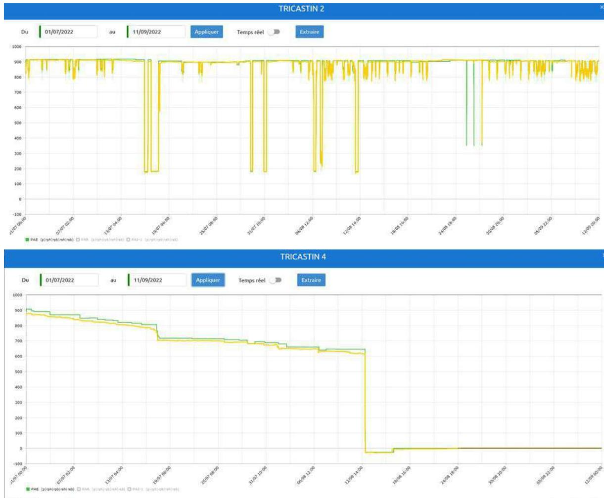
Figure 6 : Puissance (en MWe) des tranches 1, 2, 3 et 4 du CNP du Tricastin entre le 1er juillet 2022 et le 11 septembre 2022. La courbe verte correspond au programme émis par la DOAT et la courbe jaune à la puissance réelle réalisée.
