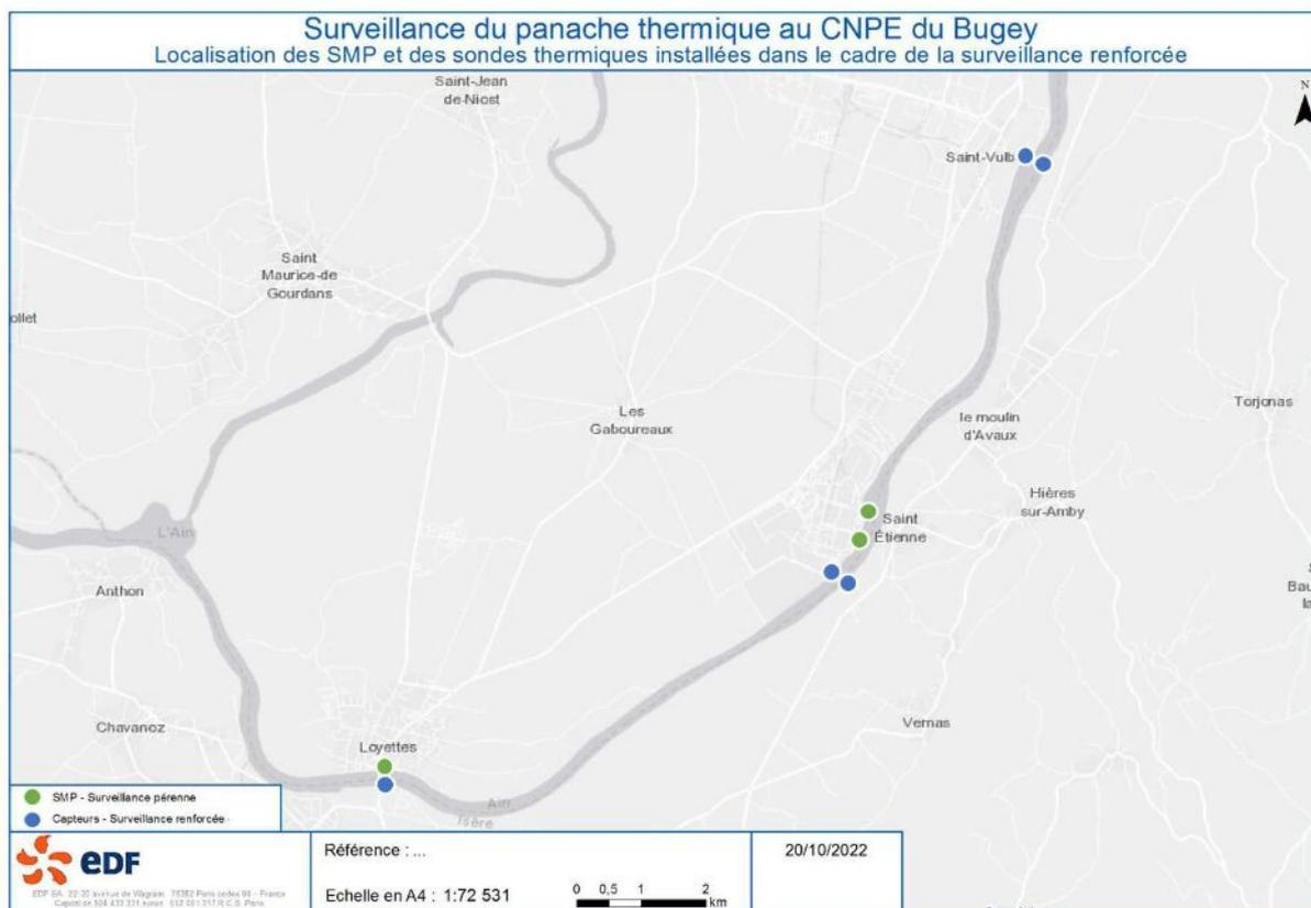
Figure 22 : Localisation des capteurs de température d'eau installés dans la cadre de la surveillance renforcée du panache thermique et du réseau de surveillance pérenne
