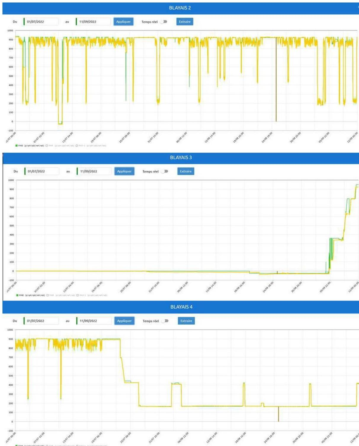
Figure 8 : Puissance (en MW) des tranches 1, 2, 3 et 4 du CNPE du Blayais entre le 1er juillet 2022 et le 11 septembre 2022. La courbe verte correspond au programme émis par la DOAAT et le courbe jaune à la puissance réelle réalisée.
