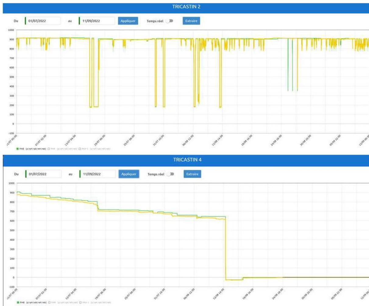
Figure 6 : Puissance (en MW) des tranches 1, 2, 3 et 4 du CNPE du Tricastin entre le 1er juillet 2022 et le 11 septembre 2022. La courbe verte correspond au programme émis par la DOAT et le courbe jaune à la puissance réelle réalisée.
