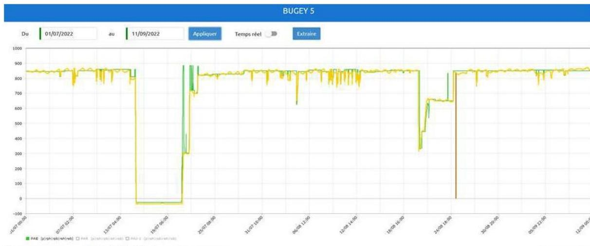
Figure 4 : Puissance (en MW) des tranches 2, 3, 4 et 5 du CNPE du Bugey entre le 1er juillet 2022 et le 11 septembre 2022. La courbe verte correspond au programme émis par la DOAAT et le courbe jaune à la puissance réelle réalisée.
