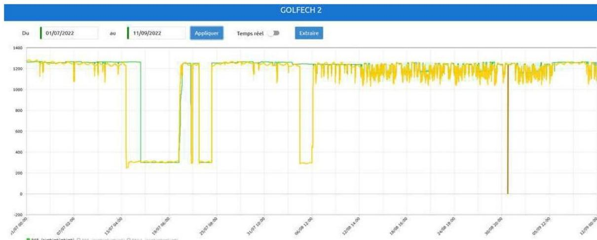
Figure 7 : Puissance (en MW) des tranches 1 et 2 du CNPE de Golfech entre le 1er juillet 2022 et le 11 septembre 2022. La courbe verte correspond au programme émis par la DOAAT et la courbe jaune à la puissance réelle réalisée.
