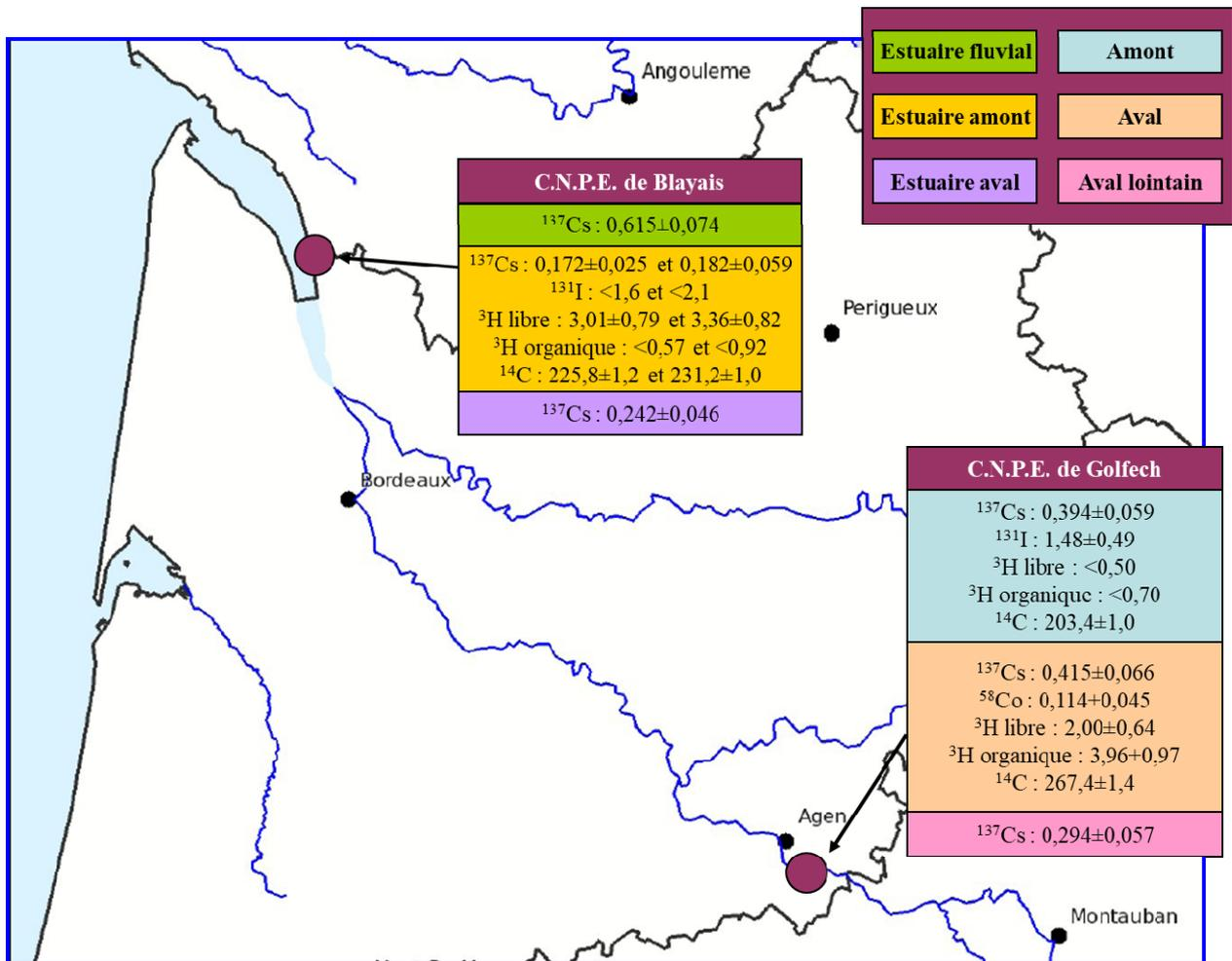
Figure 7-4. Synthèse des activités des radionucléides artificiels, du  $^{14}\text{C}$  et du  $^3\text{H}$  détectés dans les végétaux aquatiques prélevés en 2020 dans l'environnement des C.N.P.E. du bassin de la Garonne.
