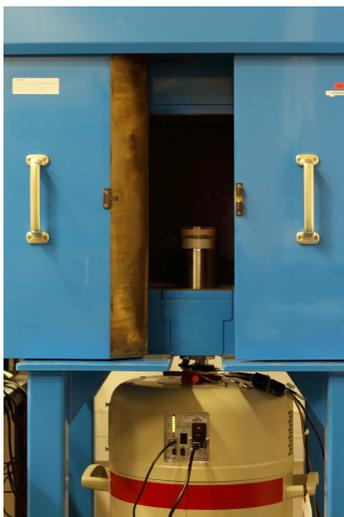
Photo 7. Chaîne de spectrométrie gamma
