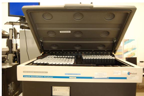
Photo 8. Appareil à scintillation liquide
