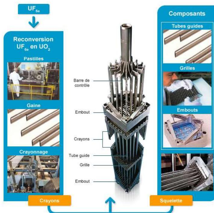
Figure 4 : Structure d'un assemblage de combustible (source Framatome)
