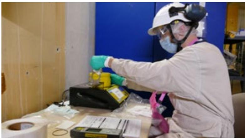
Un technicien radioprotection procède à des contrôles surfaciques
