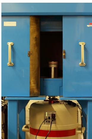
Photo 8. Chaîne de spectrométrie gamma
