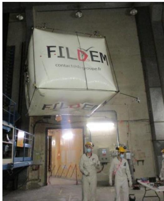
Figure 15 : Utilisation du SKYROV pour cartographier les mesures en hauteur
