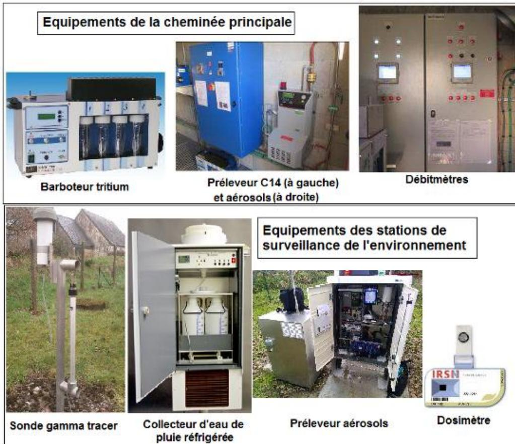
Figure 10 : Exemples de matériels de surveillance de l'environnement utilisés par le site
