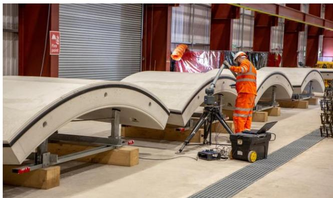
*L'étape de fabrication des segments de béton formant la paroi des tunnels de prise et de rejet d'eau est maintenant terminée. Depuis le début de la production en 2019, plus de 45 000 segments ont été fabriqués.*
