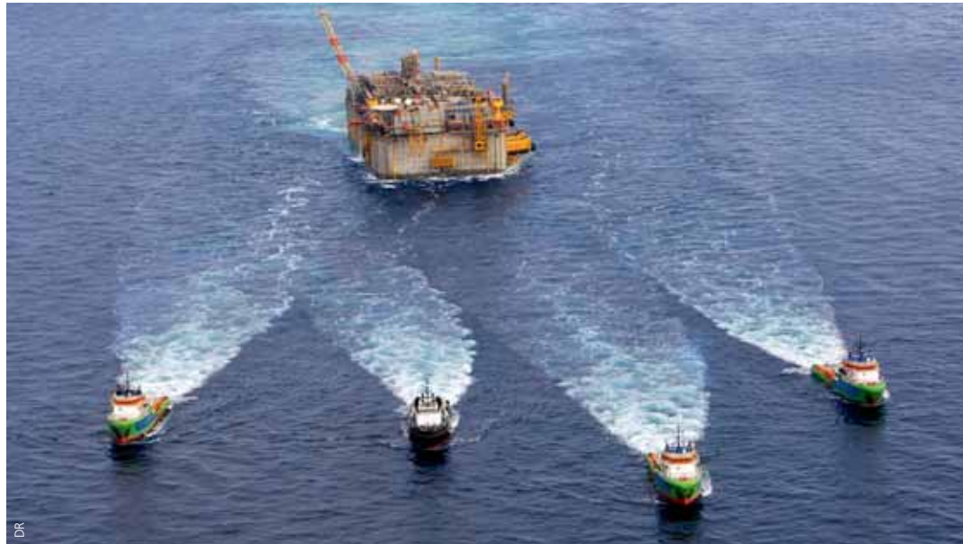
Remorqué depuis l'Espagne, le terminal de regazéification a été installé en septembre 2008 à Rovigo, dans l'Adriatique.
