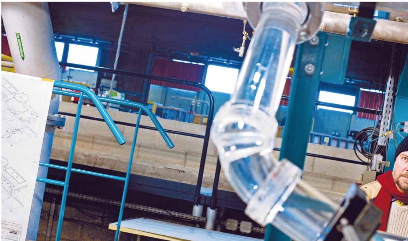
Les équipes d'EDF R&D améliorent la performance et la sûreté des installations. Ici, travail sur la boucle CARERRA, pour optimiser le circuit de refroidissement du réacteur à l'arrêt.
