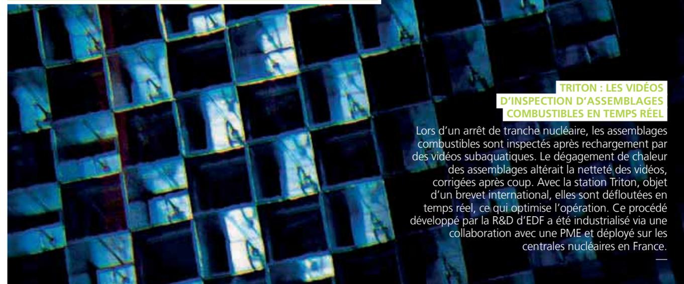
**TRITON : LES VIDÉOS D'INSPECTION D'ASSEMBLAGES COMBUSTIBLES EN TEMPS RÉEL**
