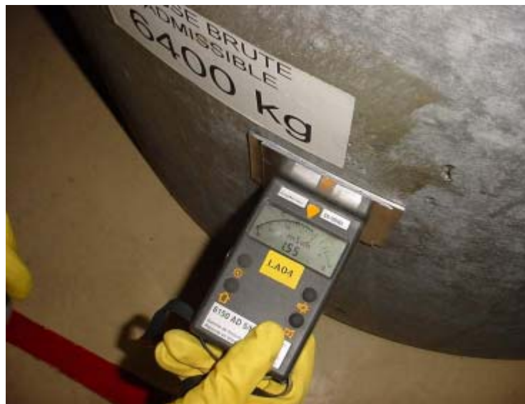
Figure 10 : mesure effectuée sur un colis de déchet
