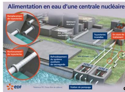
Dans le cadre de son programme de maintenance de ses équipements, EDF a réalisé, sur l'ensemble du parc en exploitation, des contrôles sur certaines tuyauteries situées dans les stations de pompage\* servant à la filtration et à l'approvisionnement en eau des centrales nucléaires en cas d'incendie.
