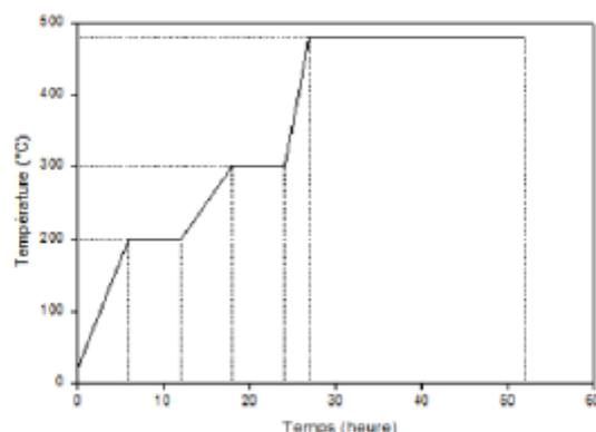
Figure 9 - Chronique d'une incinération : montée en température et paliers en fonction du temps.
