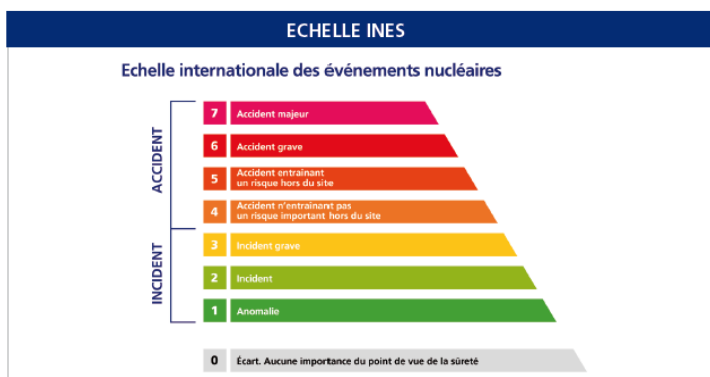
INES (International Nuclear Event Scale). Échelle de classement internationale des événements nucléaires conçue pour évaluer leur gravité.
