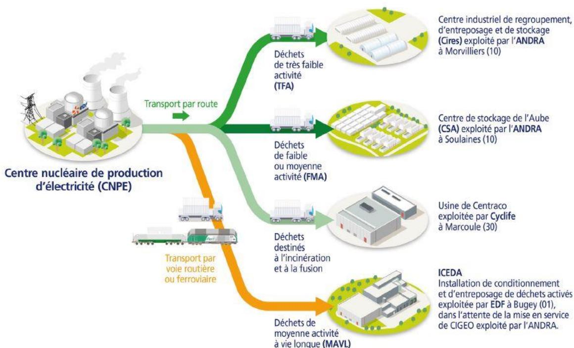
Figure 1 : Transport des déchets radioactifs (Source : EDF)
