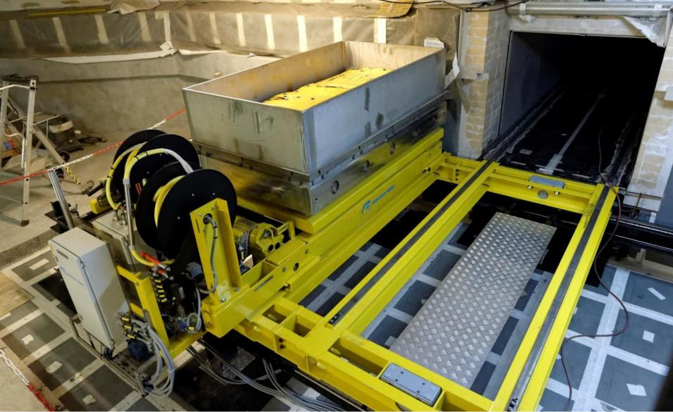
Le chariot mécanique permettant d'insérer le bouchon fusible sous la cuve est en place dans le récupérateur de corium.
