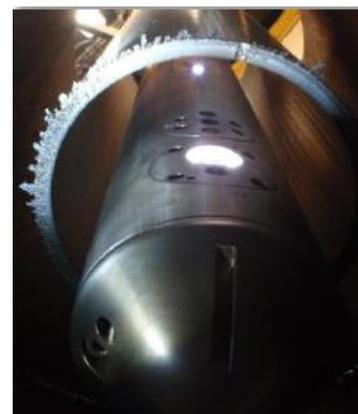
Extrémité d'ELOÏSE avec ses 2 caméras (bouchons éclairés) et la buse de la tête laser (bouchon non éclairé).
