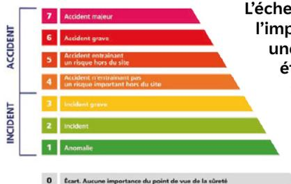
L'échelle INES permet de situer l'importance d'un événement arrivé dans une centrale nucléaire française ou étrangère. Elle comporte 7 échelons, classés du niveau 1 (l'anomalie) au niveau 7 (accident majeur). Les écarts sont représentés au niveau 0. Ils ne sont pas classés dans l'échelle car sans conséquence du point de vue de la sûreté.
