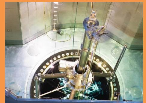
Ensuite, les équipes de la centrale de Cattenom ont réalisé l'épreuve hydraulique du circuit primaire qui vise à assurer la conformité des tuyauteries, soudures et robinets de ce dernier. Pour ce faire, le circuit a été monté en pression jusqu'à 206 bars (1,3 fois la pression de son fonctionnement normal), ce qui permet de vérifier sa résistance et son étanchéité.
