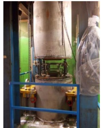
*Les tronçons de bouteilles sont ensuite déposés dans l'atelier de découpe horizontal, en passant par le toit de l'atelier spécifiquement conçu pour s'ouvrir lors des opérations de maintenance et pour assurer le confinement lors des opérations de découpe, en étant fermé. Dans l'atelier de découpe, les opérateurs séparent à nouveau les tronçons et soudent les plaques métalliques pour les fermer.*
