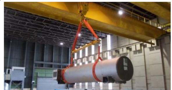
*Manutention d'un tronçon de bouteille d'échangeur de chaleur pour sa mise en conteneur avant évacuation vers l'ANDRA.*
