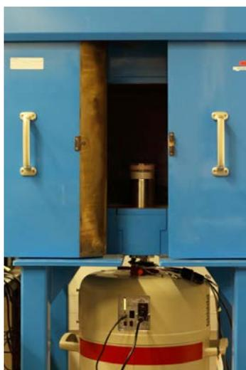
Photo 7. Chaîne de spectrométrie gamma
