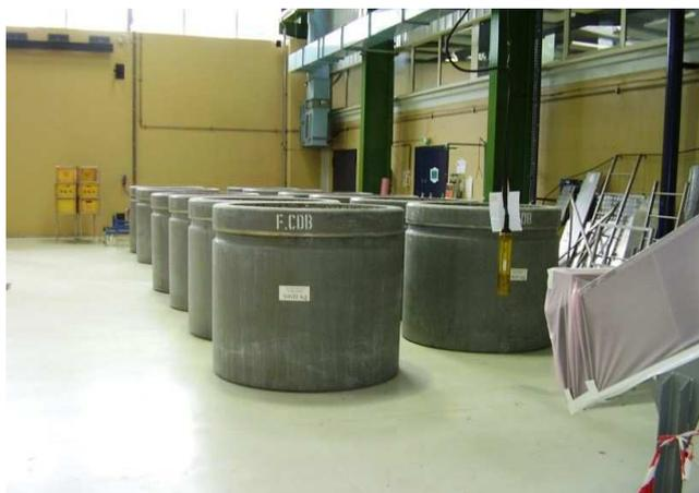
*Coques en béton entreposées au BAC*
