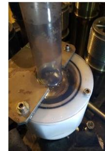
Mise en Service Industrielle 1 300 MWe de la « Limitation d'usure des manchettes thermiques » sur Nogent 2. Framatome a développé une solution qui consiste à ajouter un « compensateur » au sommet des guides de grappes ce qui évite le remplacement de la manchette.
