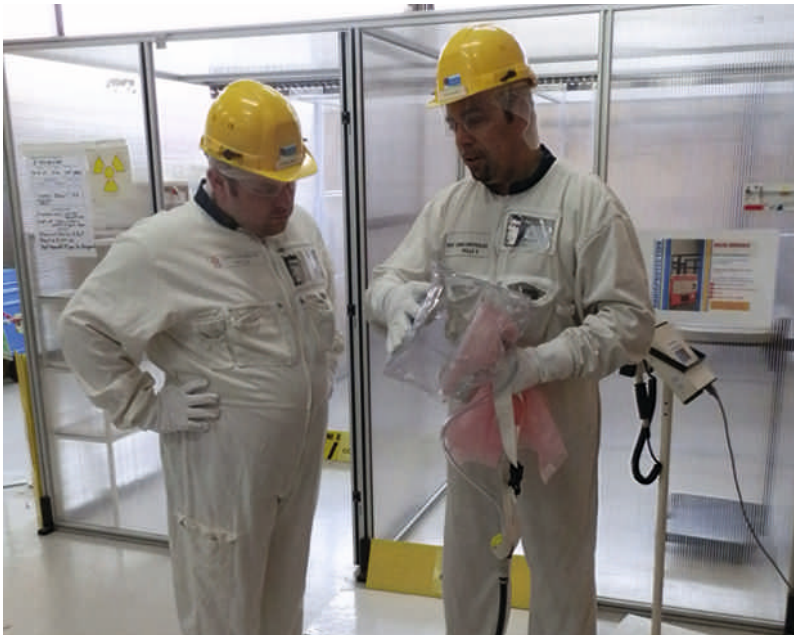
Démonstration sur chantier-école du test d'un heaume ventilé avant usage
