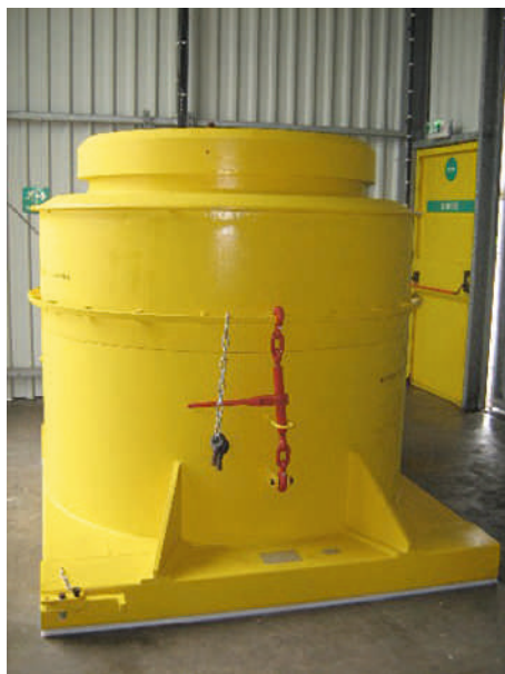
Transport interne d'une « cloche » pour une coque qui contient des filtres d'eau très irradiants Colis T12
