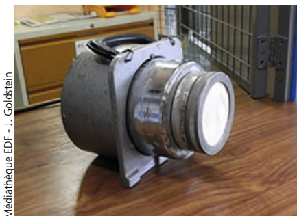
Aspirateur STAPLEX-BAUDARD Mesure réalisée par le SPR
