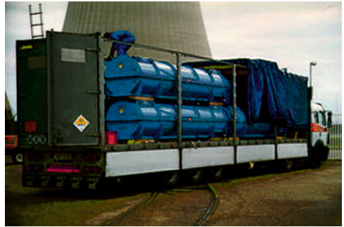
Livraison de combustible neuf par camion
