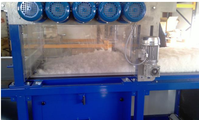
Ligne de production - Airlaying (type Spike)
