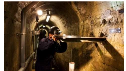
Auscultation du barrage avec un pendule EDF © François Lepage
