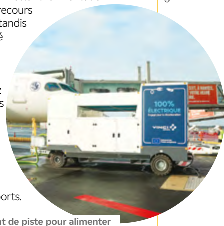
Équipement de piste pour alimenter électriquement un avion au sol.
