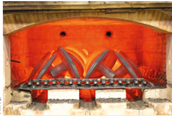
Ligne de traitement thermique de la forge Setforge L'Horme.
